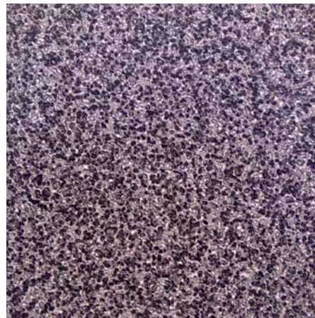
Imagen microscópica de las planchas de Alto Desempeño (DSP) @ Ampliado 200x
