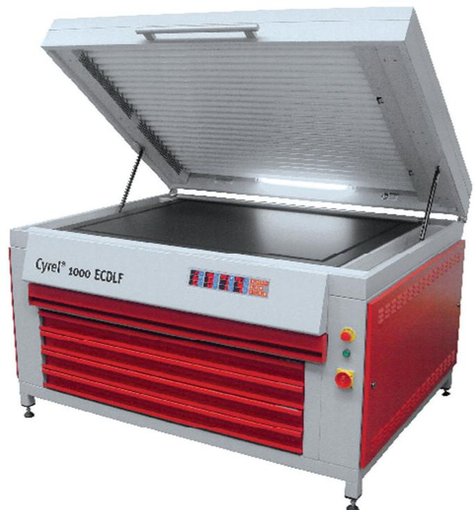
As quatro gavetas de secagem estão localizadas abaixo da seção de Acabamento com Luz. Existe um temporizador por gaveta de secagem para a regulação da temperatura. Ventiladores automáticos em todas as gavetas dão maior controle no ajuste da temperatura. O escape do fluxo de ar é monitorado por um sensor de segurança.
